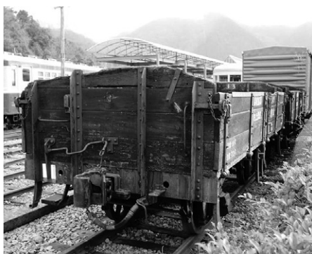
無蓋車(むがいしゃ) 砂利・鉱石・木材などの雨に濡れてもかわかない積荷を運ぶのに用いられる貨車
